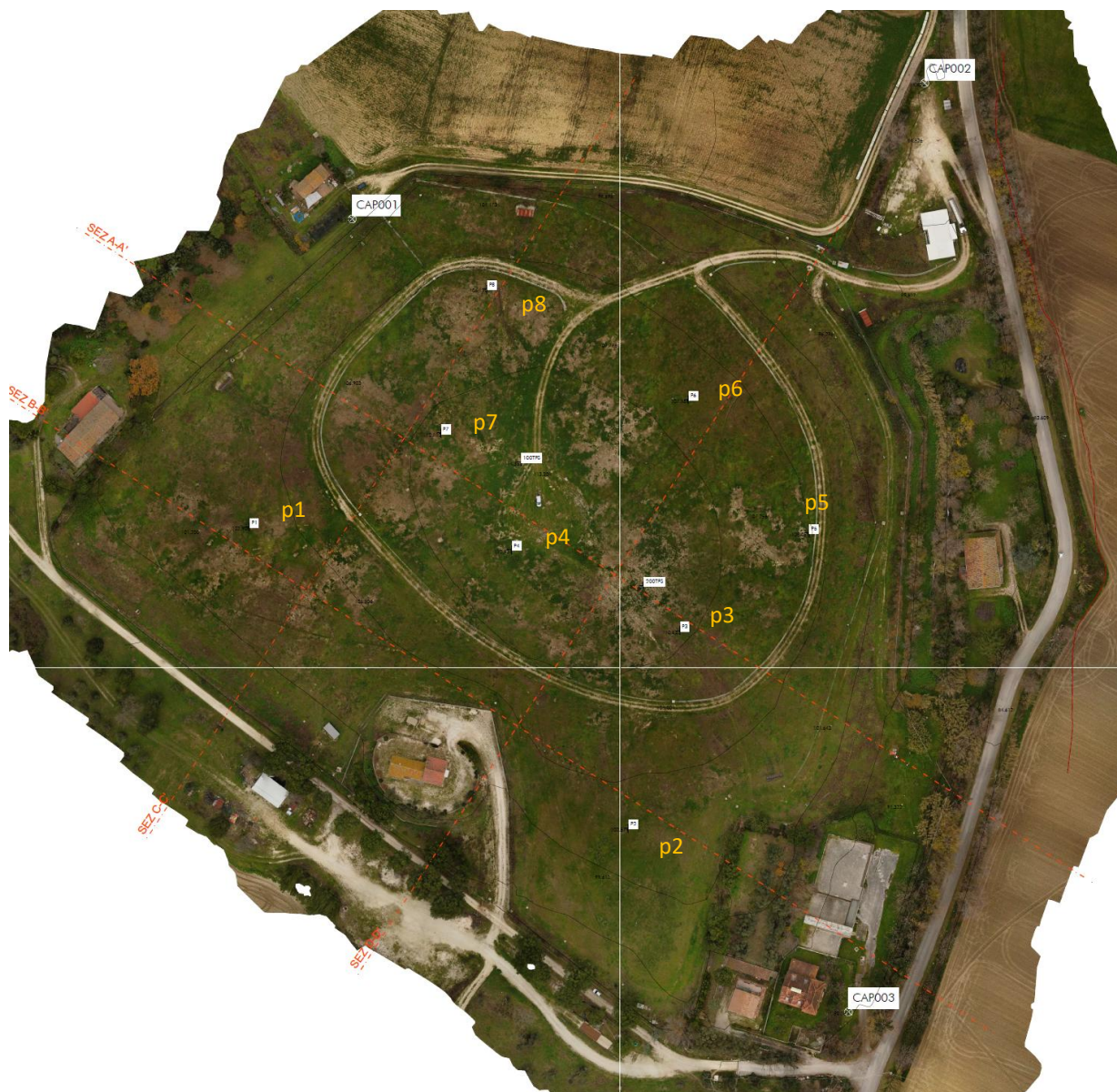
Figura 2-6: planimetria della discarica con l'ubicazione dei caposaldi di riferimento e le mire oggetto di monitoraggio
