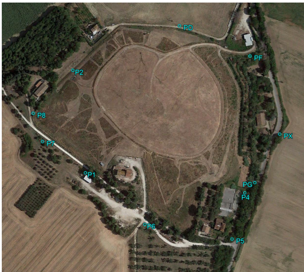
Figura 2-1: Ubicazione dei piezometri per il monitoraggio delle acque sotterranee
